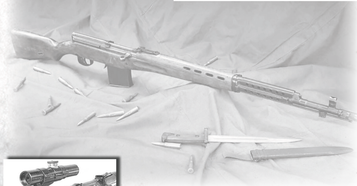
Самозарядная винтовка Токарева (СВТ, «Светка»). Внизу слева прицел ПУ, установленный на кронштейн Токарева
